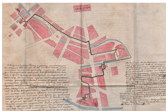
Рис. 3. Схема проектной кабельной сети для электроснабжения Императорских театров и театральных зданий Санкт-Петербурга [12].
