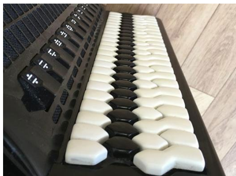
Рис. 11. Клавиатура системы Кравцова, изготовленная для концертного аккордеона на фабрике ZONTA (Молодечно, Беларусь)
